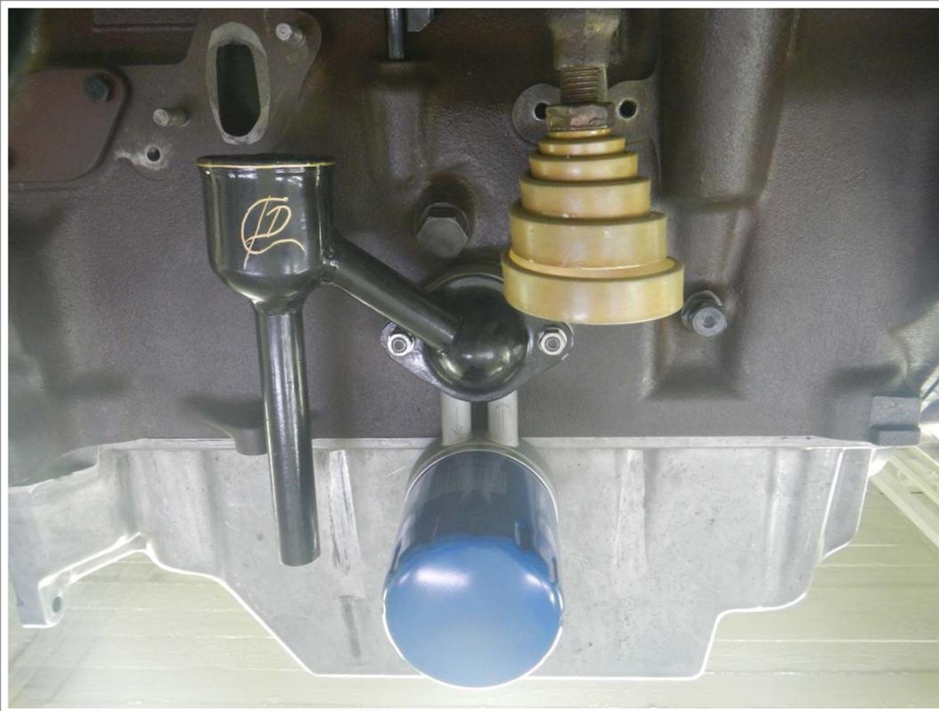
Ölfilterlösung (11CV / 15CV)
