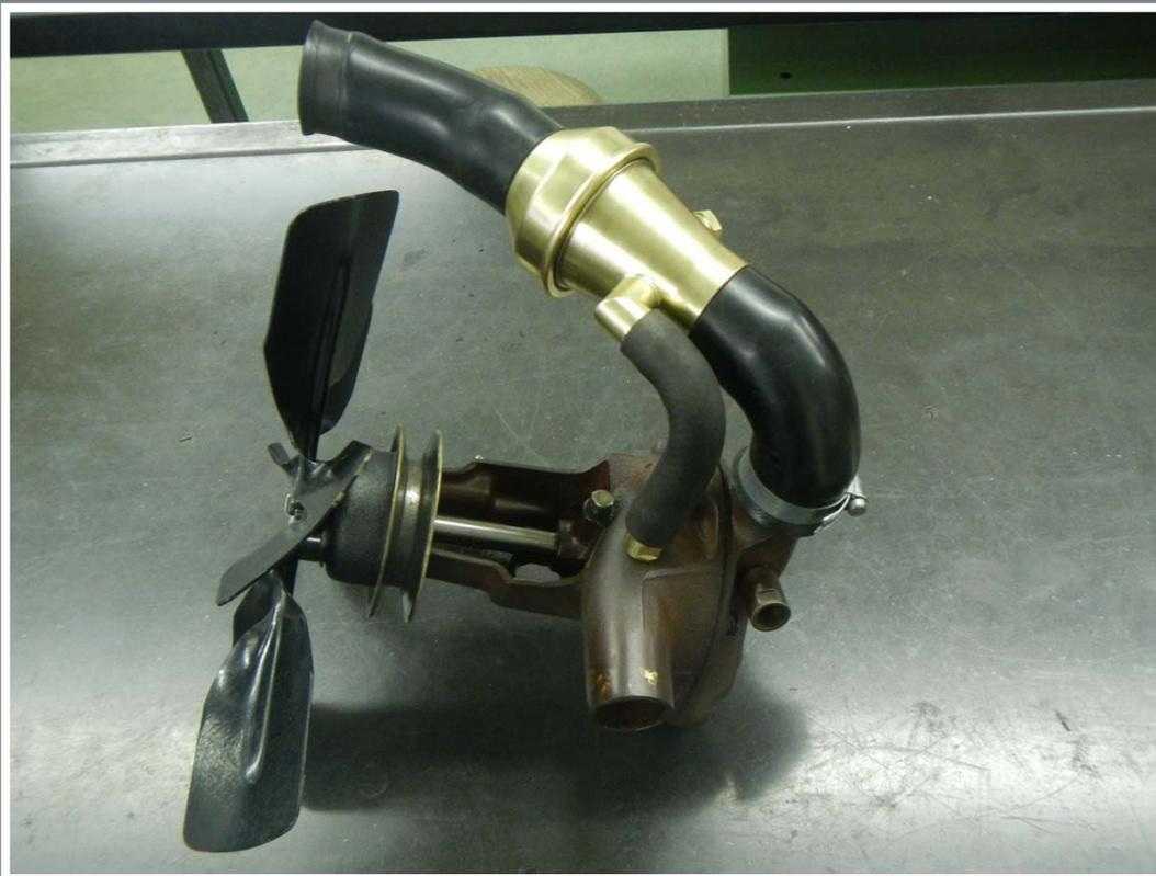
*Thermostatengehäuse mit Bypass*
